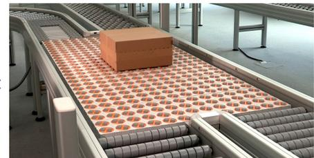
Voici le nouvel aiguillage à double croisement. (voir image 2 et 3). Il est flexible en largeur et en longueur, en fonction des plus grandes marchandises à transporter. Il déplace les marchandises des deux côtés, que ce soit en ligne droite directe ou en croisant d'une ligne en diagonale à l'autre, et ce dans les deux sens. La vitesse est réglable de 0,3 ms à 1,5 ms. Le pas des rouleaux est de 75 mm ou 37,5 mm.
